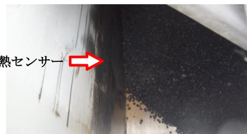
図 73: 熱センサーのポジション
