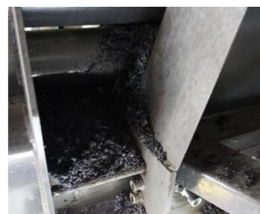
図 74: スライドレール個所のアスファルトの堆積
