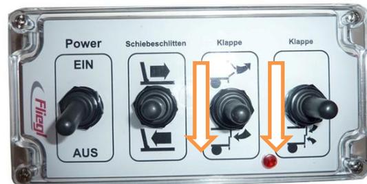
図 56:フィニッシャー稼働の際、リアゲートが閉まる
