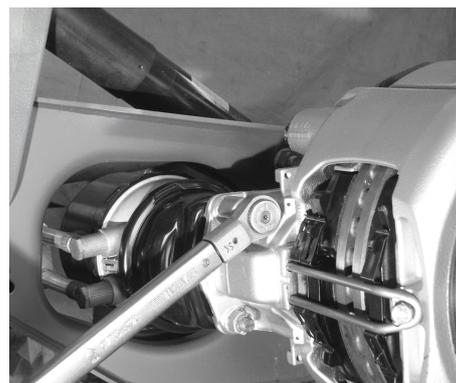
19. ABS センサーをセンサー・ホルダー内に取付けパルス・リングに接触させます。
