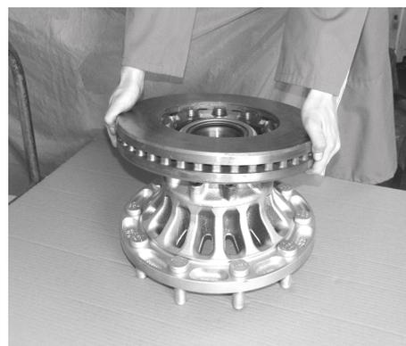
3. ハブ・ユニットのブレーキ・ディスク面との接触表面を清掃します。
