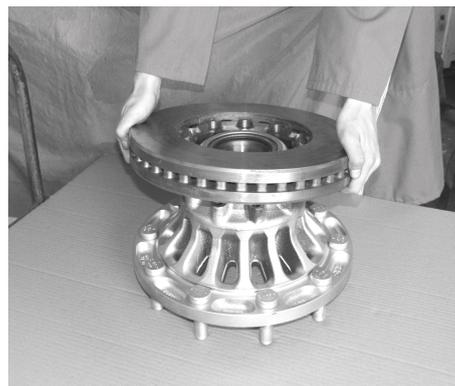
5. 新品のボルトを使用し 30Nm で対角線上に仮締めします。その後、対角線上に 90° 締めます。
