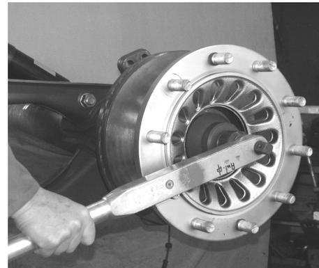
14. ハブ・キャップからオーリングを取外し、新しいオーリングに取替えた後、ハブ・キャップを取付けます。
