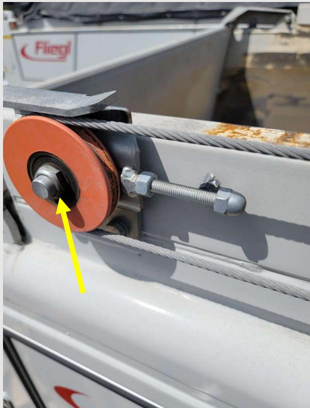
②: ①同様に滑車のボルトを緩めてから調整、①で調整出来たら②の調整は省略可。
