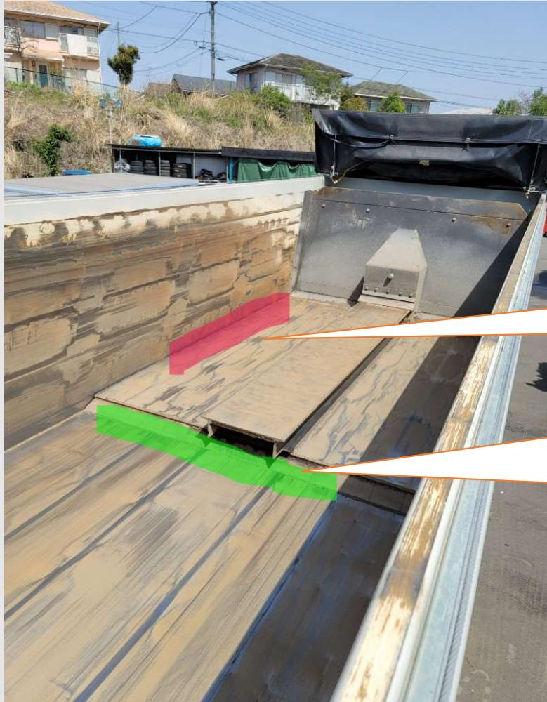
高圧洗浄では、表面の視認できる箇所以外に、可動部内側及び隙間に詰まった砂利も極力除去する。
